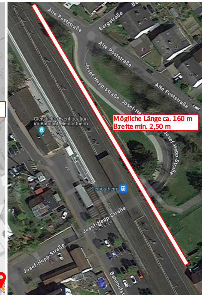
Möglicher Außenbahnsteig für barrierefreie Erschließung Bf Kleinostheim
