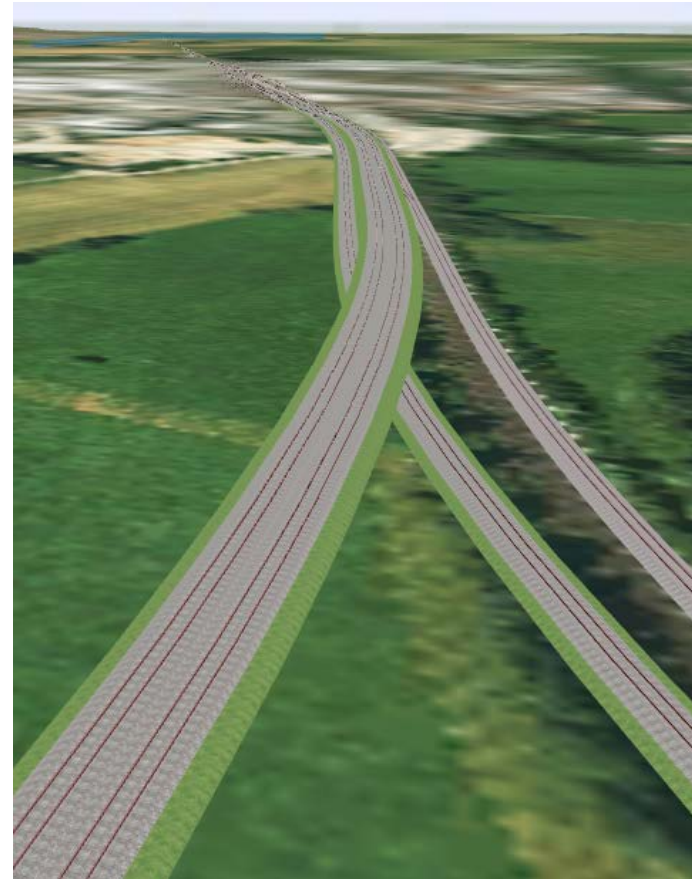
Überführung beider Gleisen bei „schnelle Gleise innen“
