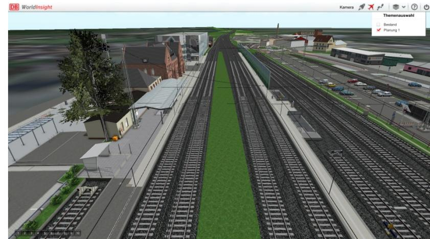
Rückbau Mittelbahnsteig, Neubau südlicher Bahnsteig, Errichtung von drei Aufzügen mit Anpassungen bzw. Neubau der Personenunterführung.
