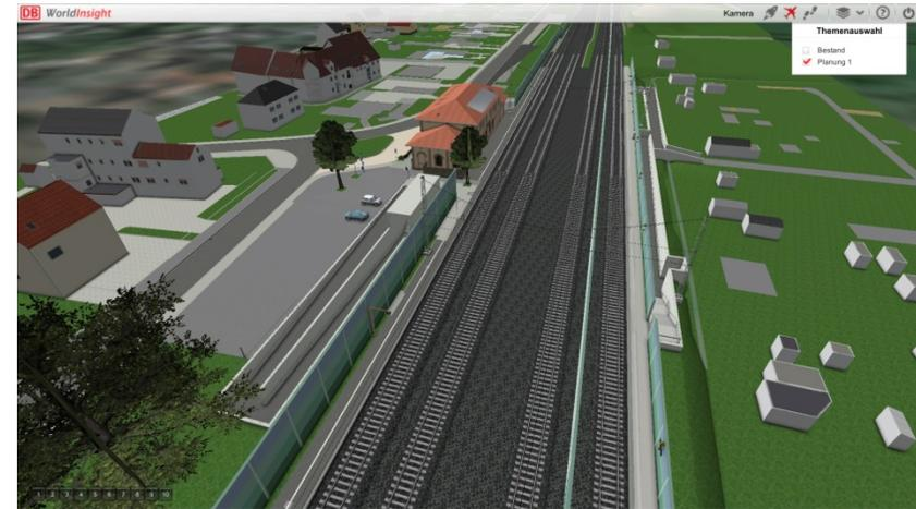
Umbau Bahnhof Hailer-Meerholz zum Haltepunkt, Rückbau des Mittelbahnsteiges, Neubau der planfestgestellte Fuß- und Radwegunterführung als Durchbindung des bisherigen Bahnsteigzuganges, Neubau des äußeren nördlichen Außenbahnsteiges.
