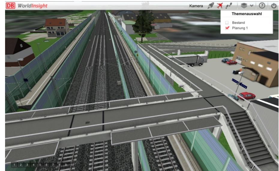
Anpassung der Fuß- und Radwegüberführung km 30,285 (Eisenbahnkreuzungsmaßnahme) sowie Errichtung von zwei neuen Außenbahnsteigen im Haltepunkt Rodenbach.
