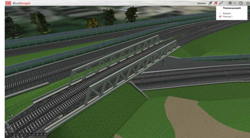
Neubau einer Eisenbahnüberführung im Zuge der Strecke 3742 in Hanau an der B 43a, südwestlich Aschaffener Straße / B8 (ABS km 24.790). Brücke wird vorgefertigt eingeschoben.
