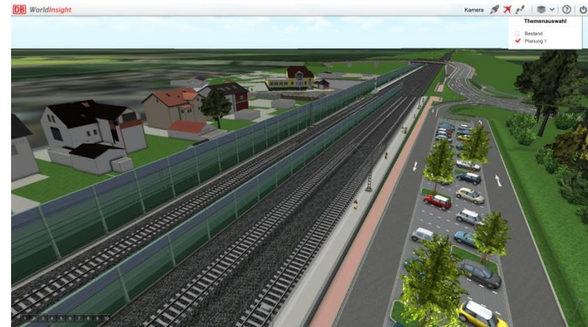
Rückbau Mittelbahnsteig und Errichtung eines neuen Außenbahnsteigs im Norden.
